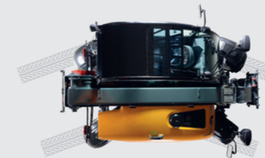
Vierradlenkung Sehr wendig in beengten Situationen aufgrund des kleinen Wenderadius.
