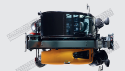
Hundegang Ermöglicht das Fahren und Arbeiten nah an Wänden.
